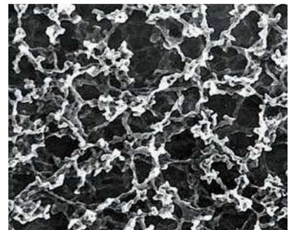
Microfotografia della struttura di filtro diversi: in cellulosa (a sinistra), in fibra di vetro borosilicato (al centro) e membrana porosa (a destra).
