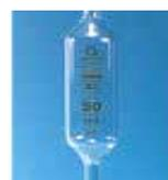
**Pipette tarate.** Sono tubi con una bolla centrale. Nei modelli a svuotamento totale una tacca nella parte superiore del tubo indica con esattezza il volume fisso dichiarato. I modelli a due tacche sono più precisi ed il volume dichiarato corrisponde a quello compreso tra le due tacche.
