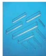
**Provette.** Dette anche tubi da saggio, sono tubi di vetro chiusi ad una estremità. Consentono saggi su piccole quantità di sostanza e di reagenti. I modelli da centrifuga hanno fondo conico e pareti robuste per sopportare forze elevate, non tollerano il riscaldamento diretto ma possono essere riscaldate a "bagnomaria".
