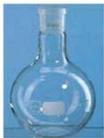
**Palloni.** Fanno di solito parte di sistemi complessi adibiti allo svolgimento di metodiche particolari. La particolare costruzione del collo, la cui parte smerigliata ha conicità standardizzata, ne permette il raccordo con altra vetreria. I palloni possono presentare anche due o più colli, per l'inserimento di termometri o di particolari strumenti. Il fondo dei palloni può essere tondo oppure piatto.
