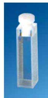
CUVETTE PER SPETTROFOTOMETRIA
