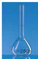
**Matracci tarati.** Utilizzati, di solito, per la preparazione di soluzioni titolate a concentrazione nota. Sul collo, lungo, stretto e dotato di tappo, è incisa una tacca che indica, con assoluta precisione, l'esatto livello di riempimento per il quale il volume di liquido inserito corrisponde alla capacità nominale del matraccio. Alcuni matracci sono realizzati con vetro a freddo quindi non possono essere usati per il riscaldamento di soluzioni o liquidi.
