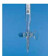
**Burette graduate.** Si presentano come lunghi tubi graduati provvisti, nella parte inferiore, di un rubinetto. Lo zero della scala graduata è situato in alto ed è quindi possibile misurare con accuratezza le quantità di liquido fatto defluire. Sono disponibili con diverse capacità e anche con forme particolari per specifici dosaggi.
