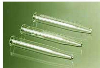
**PROVETTE CONICHE IN VETRO PER CENTRIFUGA CON TAPPO**
