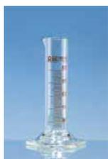
**Cilindri graduati.** Sono strumenti di misura sebbene le loro caratteristiche costruttive non consentano di ottenere gli stessi livelli di accuratezza e precisione garantite dai matracci tarati. I cilindri sono disponibili con diverse capacità, diametri e lunghezze. Le loro scale di misura possono essere suddivise a gradi diversi e con diversi livelli di sensibilità. Anche i cilindri sono generalmente costruiti in vetro borosilicato.
